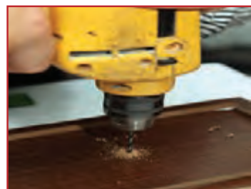
پ- سوراخ کردن در جعبه با دریل
