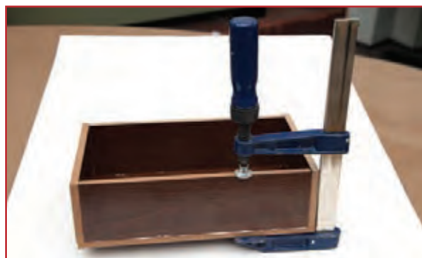
شکل ۷-۱۶- بستن جعبه به وسیله پیچ دستی
