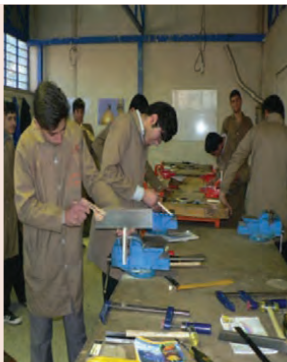
شکل ۱۰-۷- استفاده از میز کار و گیره
