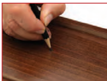
ب- مشخص کردن مرکز در با مداد
