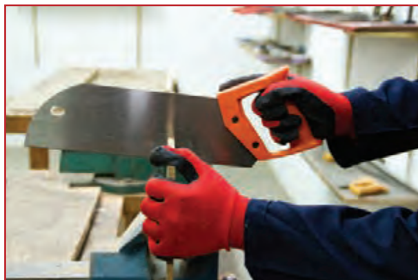
الف- برش دادن شیار
