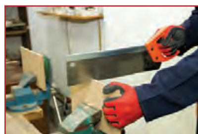
الف- بریدن قطعات با اره ظریف بر
